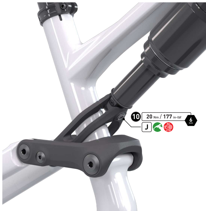
Rear shock mounting bolt / 後避震器安裝螺栓 / Vis fixation d'amortisseur arrière / Hintere Dämpferbefestigungsschraube / Parafuso de montagem do amortecedor traseiro / Tornillo trasero de montaje del amortiguador
